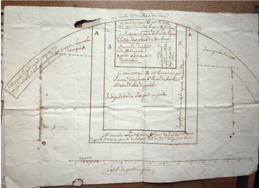
Figure 7 – Rare plan conservé d'aménagement d'un chœur ; l'embarquement est dessiné, plus large que long, il s'adapte à l'étroitesse des lieux (Arch. dép. Finistère, 105 J 208) (cl. Y. Celton)
